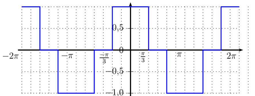
On s'intéresse au développement en série de Fourier du signal  $g$ .
